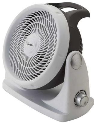
Termoventilatore con unità riscaldante orientabile, dirige con precisione il caldo. Unità riscaldante girevole. Griglia frontale con alette radiali curve. Selettore: 0/ Ventilazione/ Eco (1000W)/ Rapid (2000W). Termostato regolabile. Corpo in plastica con maniglia integrata. Idoneo per **ambienti di 20m<sup>2</sup>**. 230V~ 50Hz 2000W
